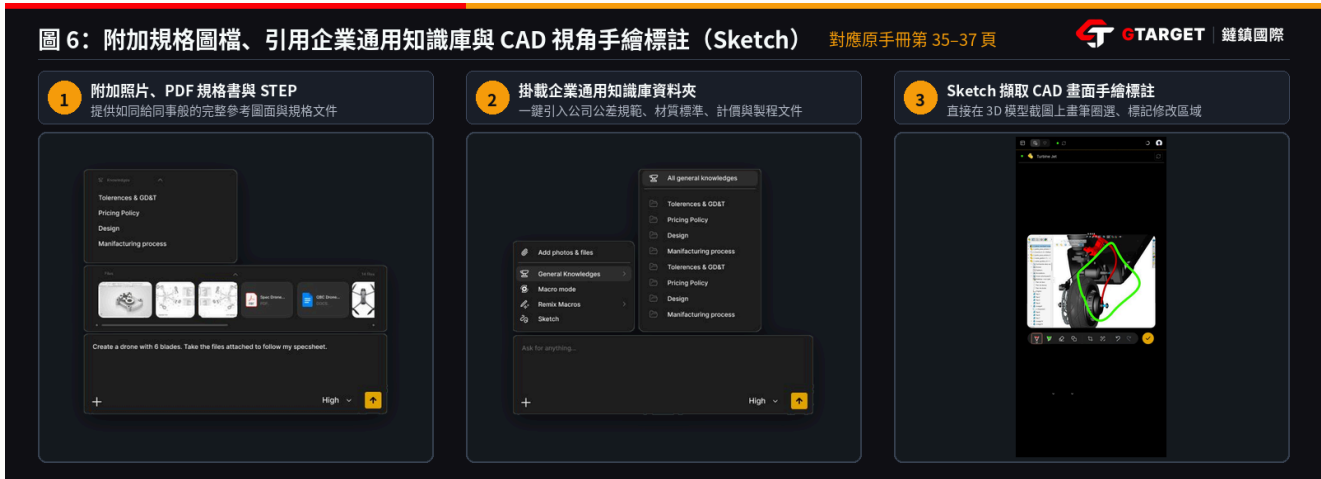
圖 6：(1) 附加多份 PDF 規格書與工程圖；(2) 從選單掛載企業通用知識庫資料夾；(3) 使用 Sketch 工具直接在 CAD 視角截圖上圈選標註。
