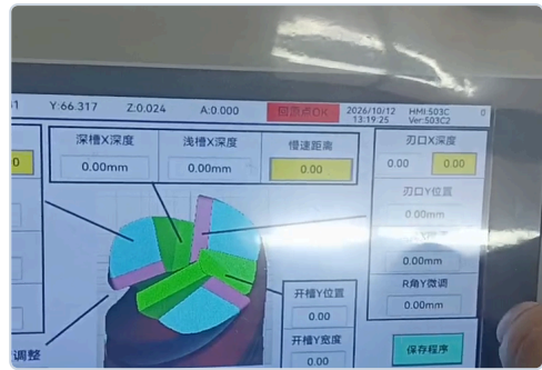
圖 6：刀具參數介面配置（中央端面剖面圖，兩側微調欄）
