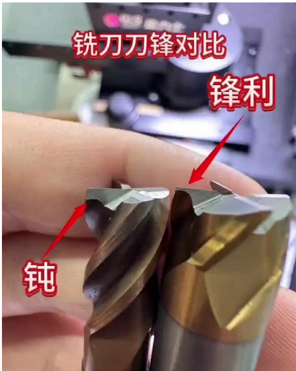
圖 7.1：影片實測特寫——磨損舊刀（左側：鈍）與修磨新刃（右側：鋒利）對比
